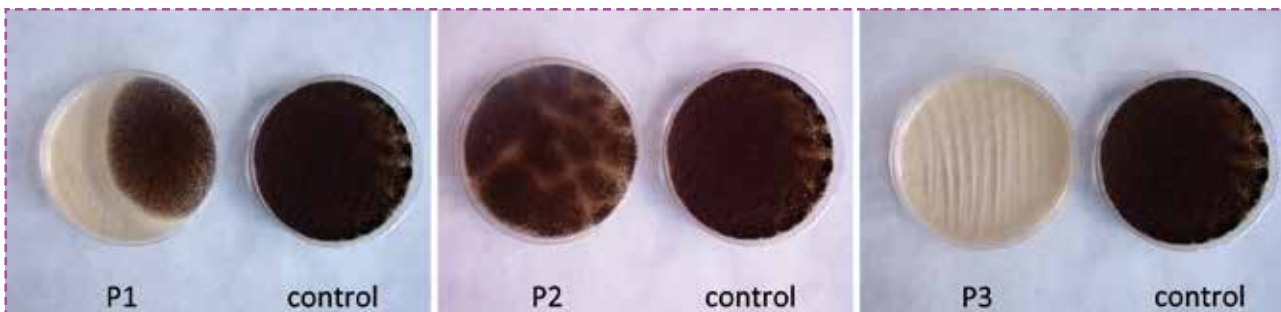
Fig. 3-5. Resultados obtenidos tras la aplicación de los tres productos ensayados sobre material contaminado con Aspergillus niger transcurridos sesenta días de la aplicación. P1 y P2: Productos antisépticos de uso habitual. P3: Alcohol: Agua (70:30).
